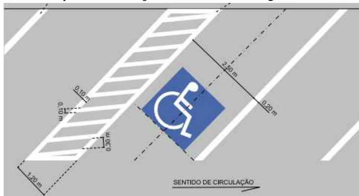
Medidas para sinalização horizontal de vagas inclinadas.
